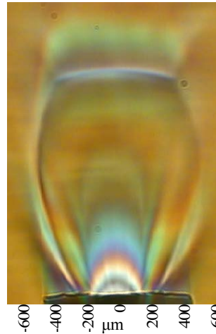
RAINBOW SCHLIEREN DEFLECTOMETRY (RSD)
